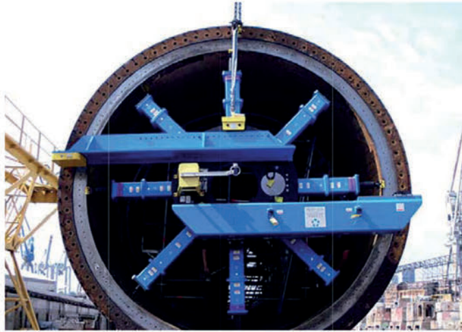
Bearbeitung eines FPSO Turretflansches mit der CM6200
